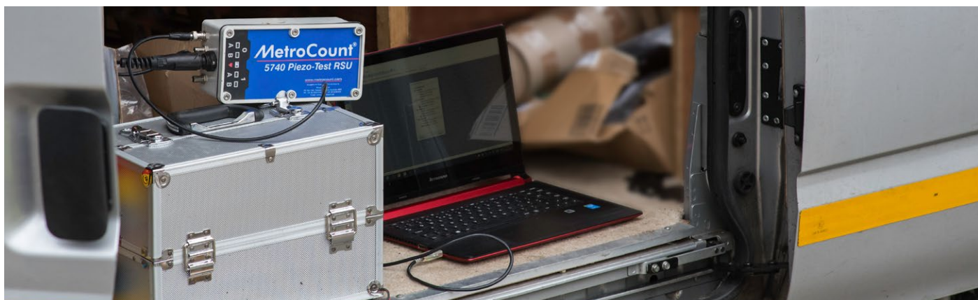
De MC Piëzo Test is de toonaangevende technologie voor de verificatie van piëzoelektrische sensoren.
