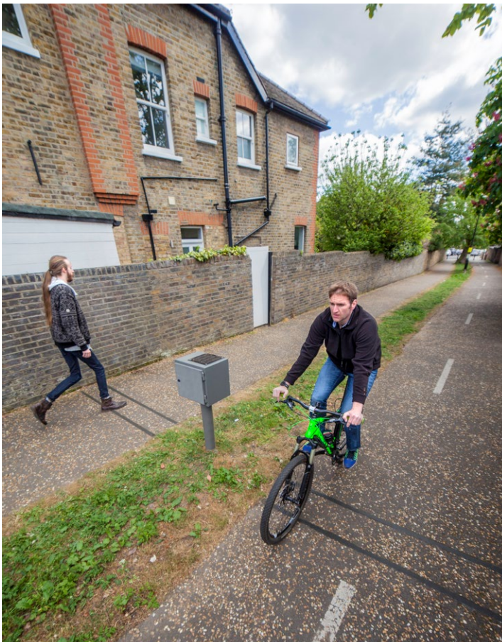
RidePod® BP telt zowel fietsers als voetgangers. in een MetroCount kastje, geïnstalleerd bij een fiets- en wandelpad.
