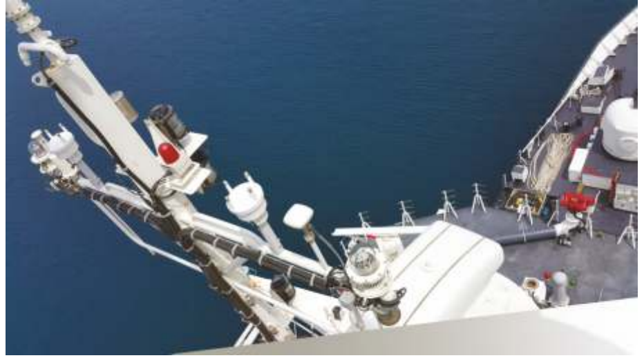
Meteos 101, Coast Guard Umur Gemisi Hava İstasyonu Sensörleri Sistemi, Aksaz - MUĞLA / 2016 Meteos 101, Sahil Güvenlik Komutanlığı Umur Gemisi Hava İstasyonu Sensörleri Sistemi, Aksaz - MUĞLA / 2016
