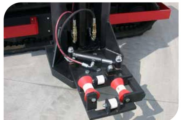
**HYDRAULISCH BETÄTIGTE UNTERE FÜHRUNG
