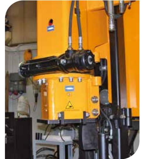
**BOUCHE DE MARTEAU ROTATIVE POUR L'ORIENTATION DES PIEUX D'ANGLE CARRÉS**
