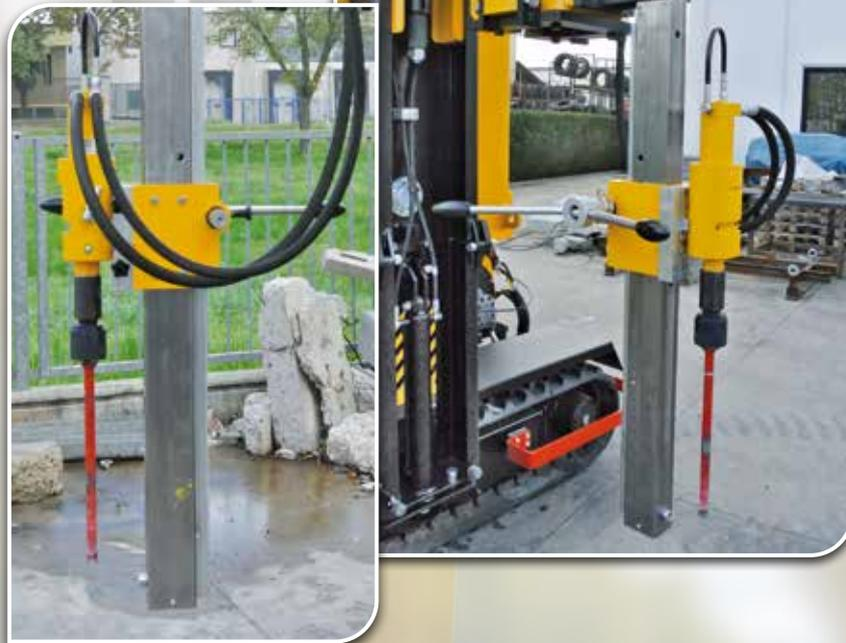
*La carotatrice idraulica viene utilizzata in combinazione con il battipalo per carotare calcestruzzo, cemento armato e conglomerati bituminosi.*
